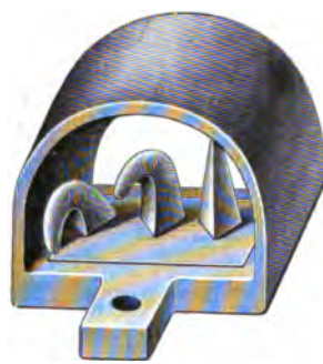
Fig. 72. — Disposition des cônes de Seger, suivant Henneberg.
